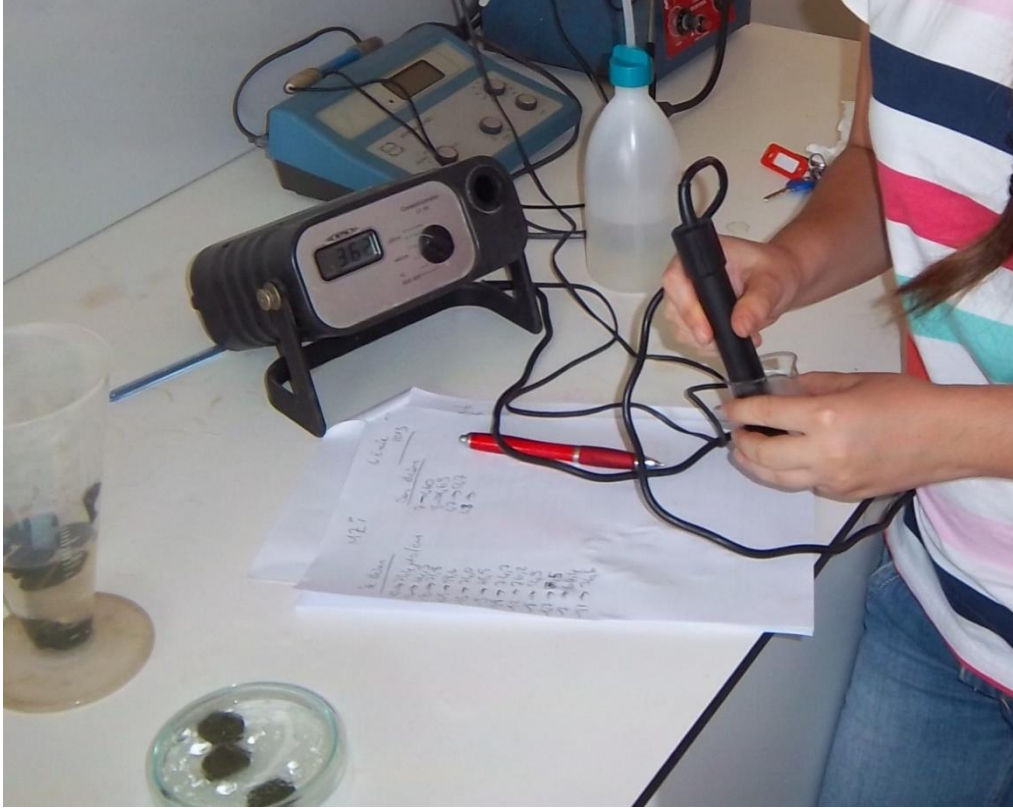
Şekil 3.13. Tuzluluk ölçer (EC metre) ile EC değerlerinin ölçümü
