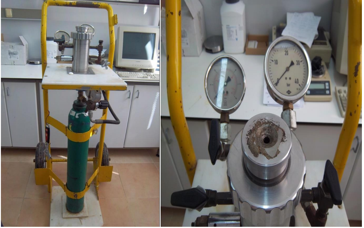
Şekil 3.8. Yaprak su potansiyeli ölçme cihazı olan Scholander basınç aleti
