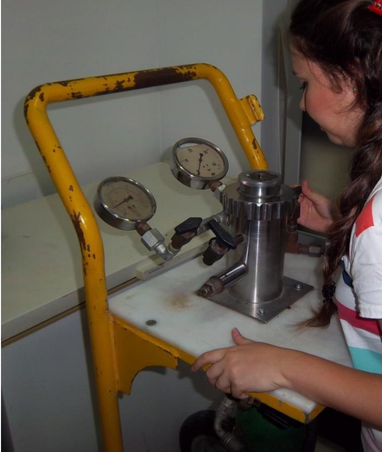
Şekil 3.9. Yaprak su potansiyeli ölçme cihazı olan Scholander basınç aleti ve yapılan ölçümlerden görünüm
