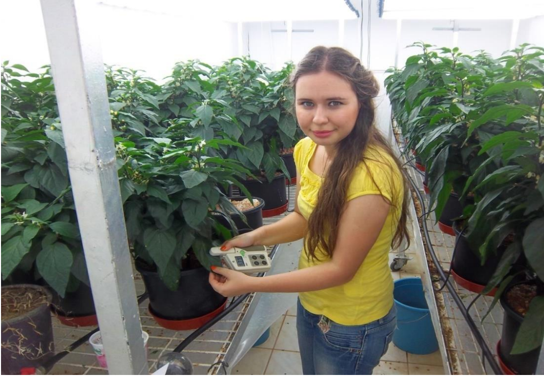
Şekil 3.15. Klorofilmetre yardımıyla biber yaprak klorofil tayini
