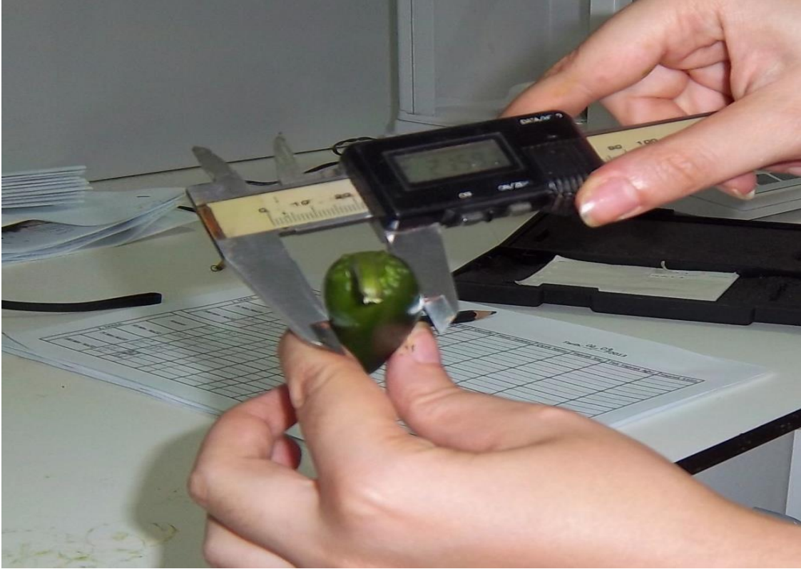
Şekil 3.19. Hasat edilen meyvelerin dijital kumpas yardımıyla meyve çapı ölçümü
