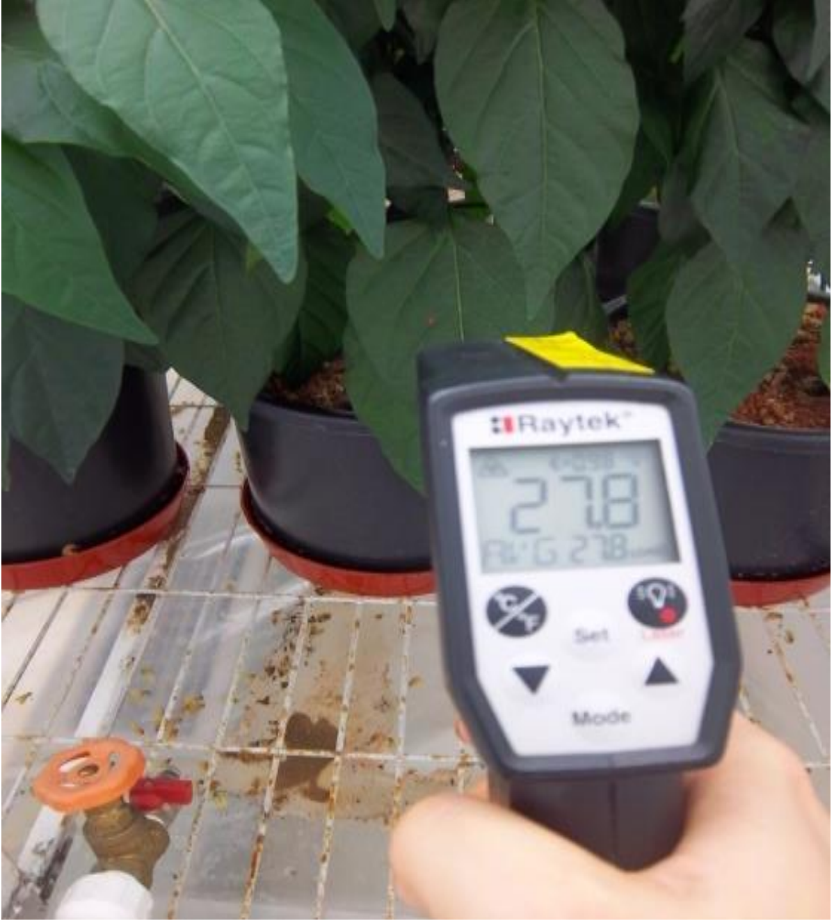
Şekil 3.14. Infrared termometre yardımıyla biber yaprak yüzey sıcaklığının ölçümü
