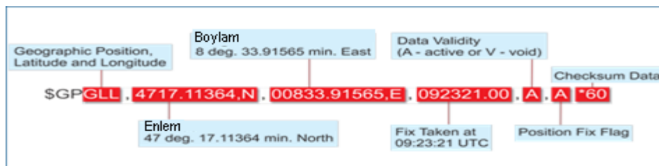
Şekil 3.14. NMEA protokol yapısı
