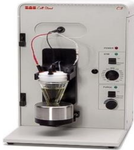
Şekil 2.5.1: Elektrokimyasal sentez için kullandığımız üçlü elektrot sistemi: monomer ve elektrolit çözeltisinde dalmış olan referans, çalışma ve karşıt elektrot.
