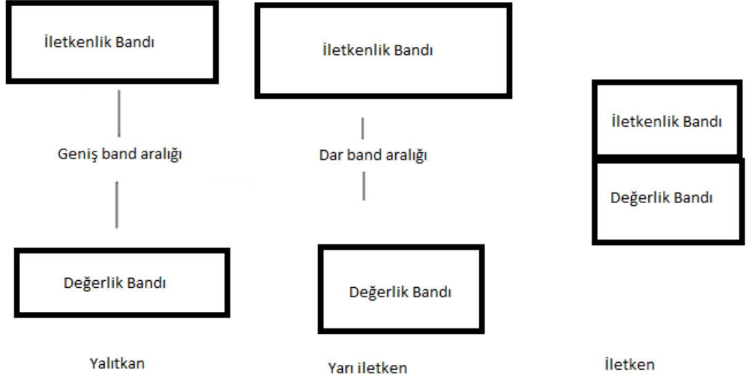
Şekil 2.4.1: İletkenlik band kuramının şematik olarak gösterimi
