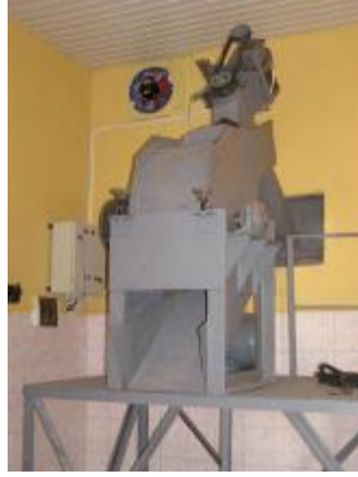
Şekil 2.4.a Andız meyvelerini kırmak için kullanılan makine (Kocakulak 2007)
