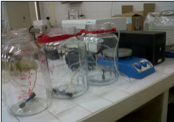
Şekil 5.5. Reaktörler ve havalandırma düzeneği
