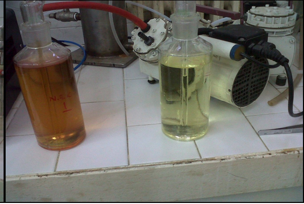
Şekil 5.4. Ozonlama sonunda KI şişelerinde yakalanan ozon ile renk değişimi
