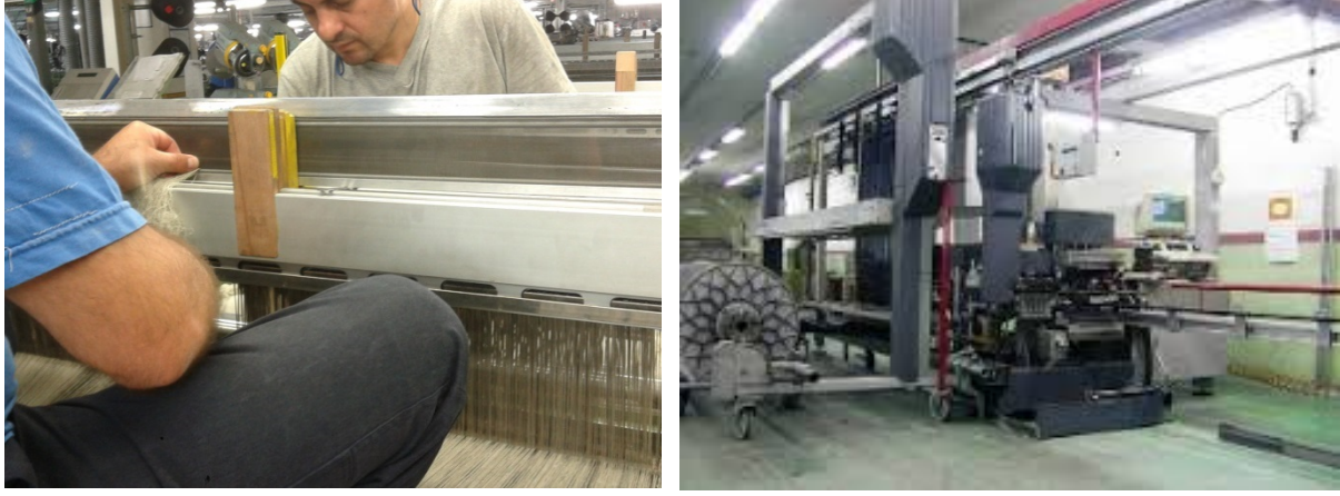
Şekil 3. Elle yapılan manuel taharlama ve Otomatik tahar makinasında taharlama
