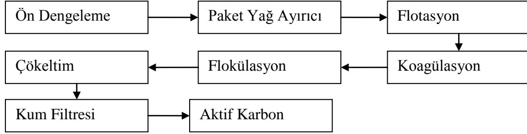
Şekil 4.4. Arıtma Tesisi Proses Şeması
