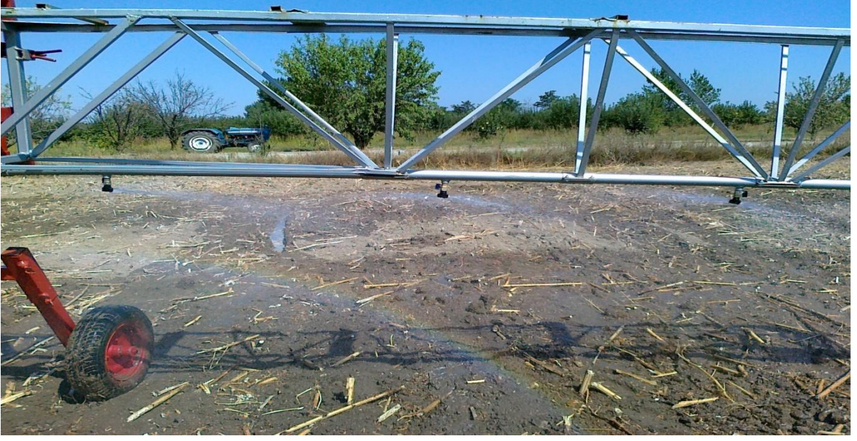
Şekil 3.3. Araştırmada kullanılan yerli üretim doğrusal hareketli yağmurlama sistemi
