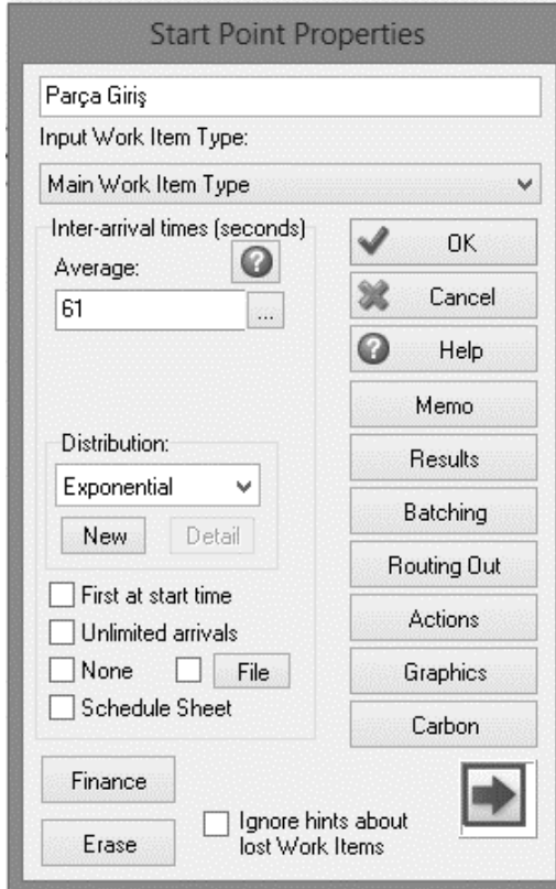
Şekil 4.7 Giriş besleme zamanının Simul8 yazılımına aktarılması
