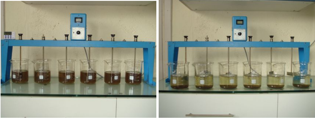
Şekil 6.2 Fenton ve kimyasal çöktürme deneylerinde kullanılan jar testi düzeneği
