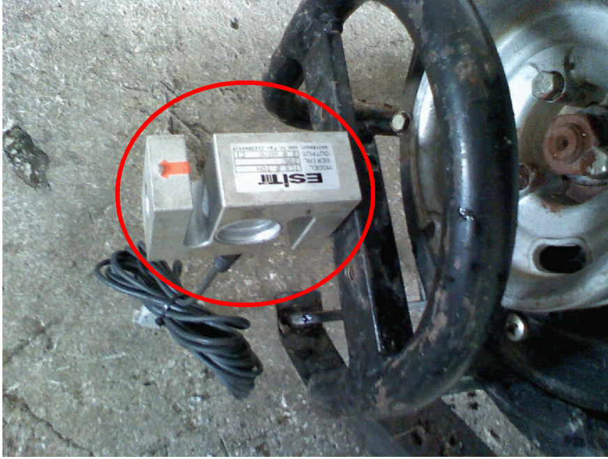
Şekil 3.21. Çeki kuvveti ölçerinin traktörün ön çeki demirine montajı – 1
