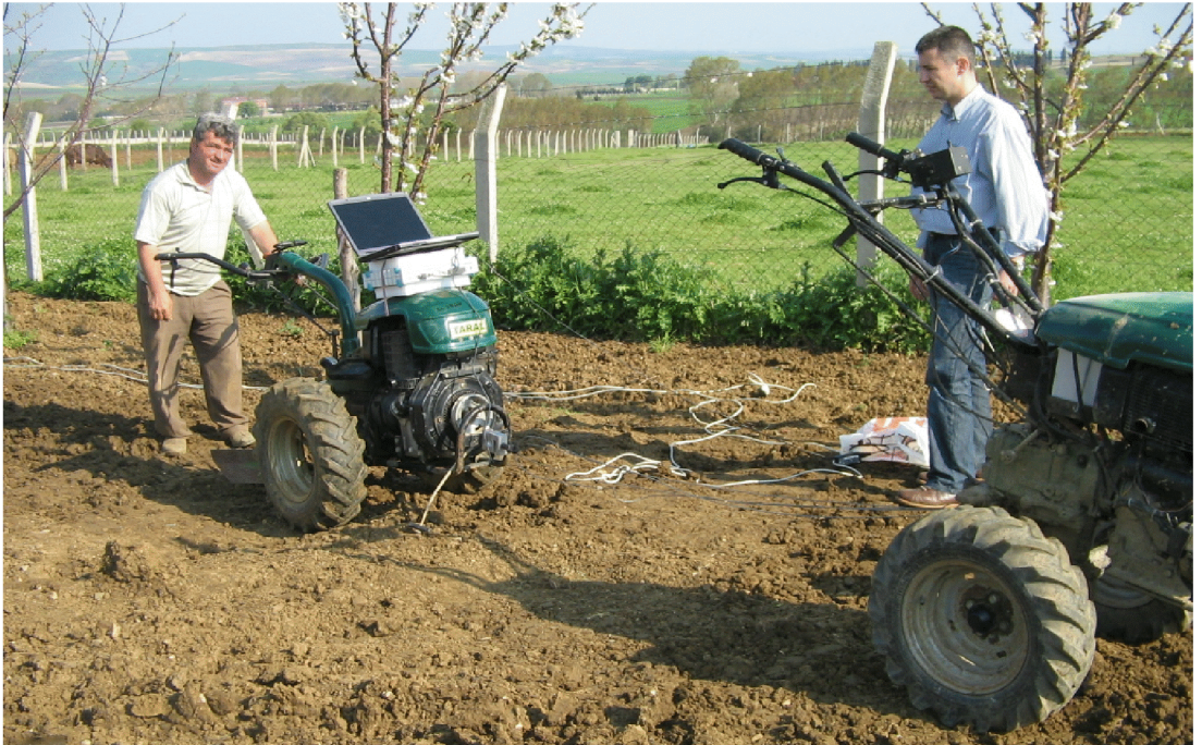
Şekil 3.24. Çeki kuvveti testi - 2
