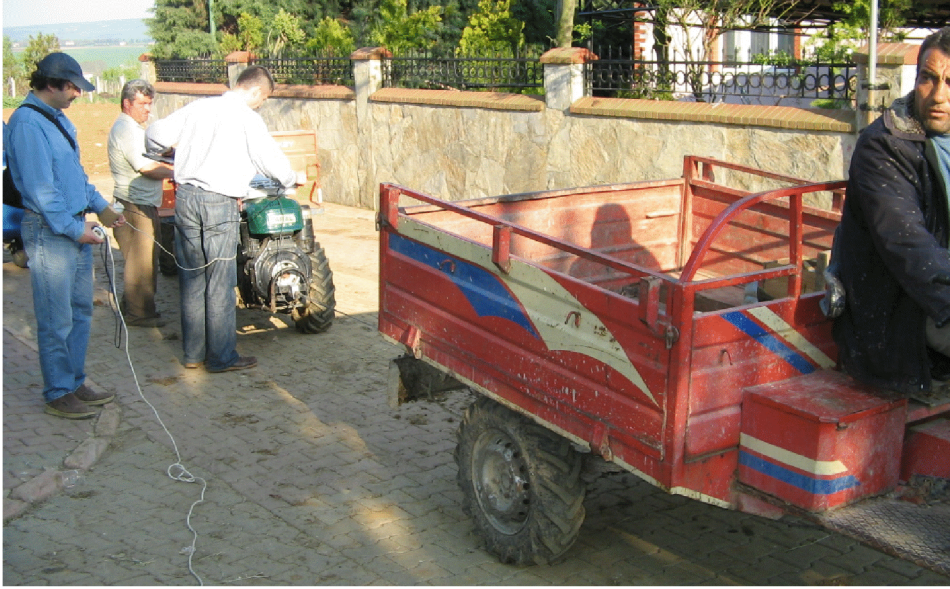
Şekil 3.27. Tarım arabası ile çeki kuvveti testi - 1
