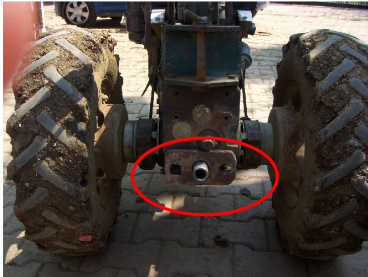
Şekil 3.15. Flanşın traktöre monte edilmiş hali
