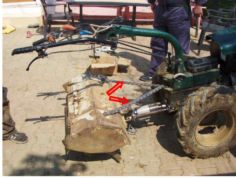
Şekil 3.19. Destekleme lamalarının monte edilmiş hali
