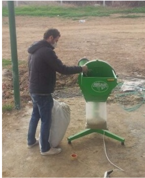
Şekil 3.2. Çeltik saplarının parçalanması
