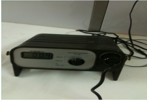
Şekil 3.8. Toprak elektriksel iletkenliğinin kondüktometre cihazı ile ölçülmesi
