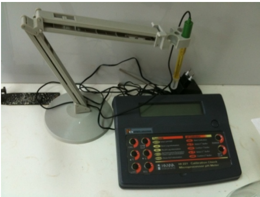
Şekil 3.4. Toprak reaksiyonunun saptanması - pH metre cihazı
