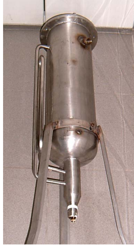
Şekil 3.2.4.1. 12 Lt'lik, AISI 304 Soxhalet ekstraksiyon düzeneği
