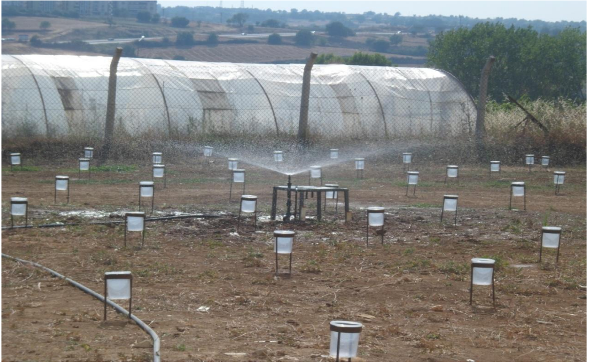
Şekil 3.8. C başlığının test edilmesi
