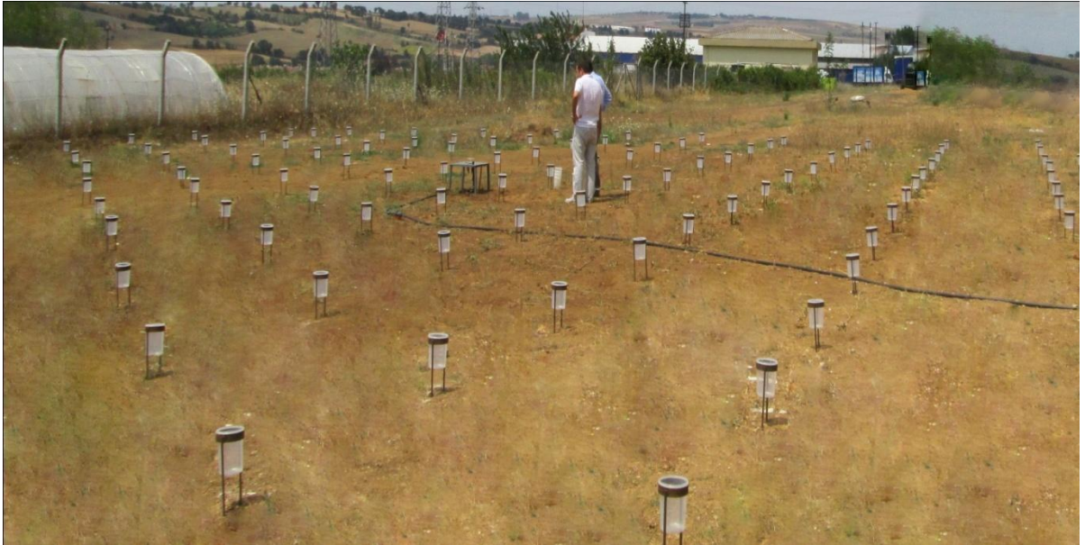
Şekil 3.1. Yağmurlama başlığı ve su toplama kapları
