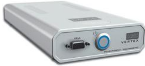
Şekil 3.2. İvium vertex potansiyostat cihazının fotoğrafı
