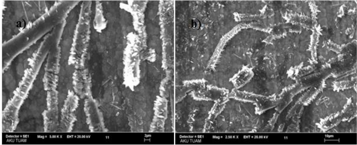
Şekil 4.27. P(N-MPy) /TiO 2 'nin Al1050 elektrot üzerine elektrokimyasal metotla kaplanması sonucu a) 5000 kat büyütme b) 2500 kat büyütme sonucu elde edilen SEM görüntüsü
