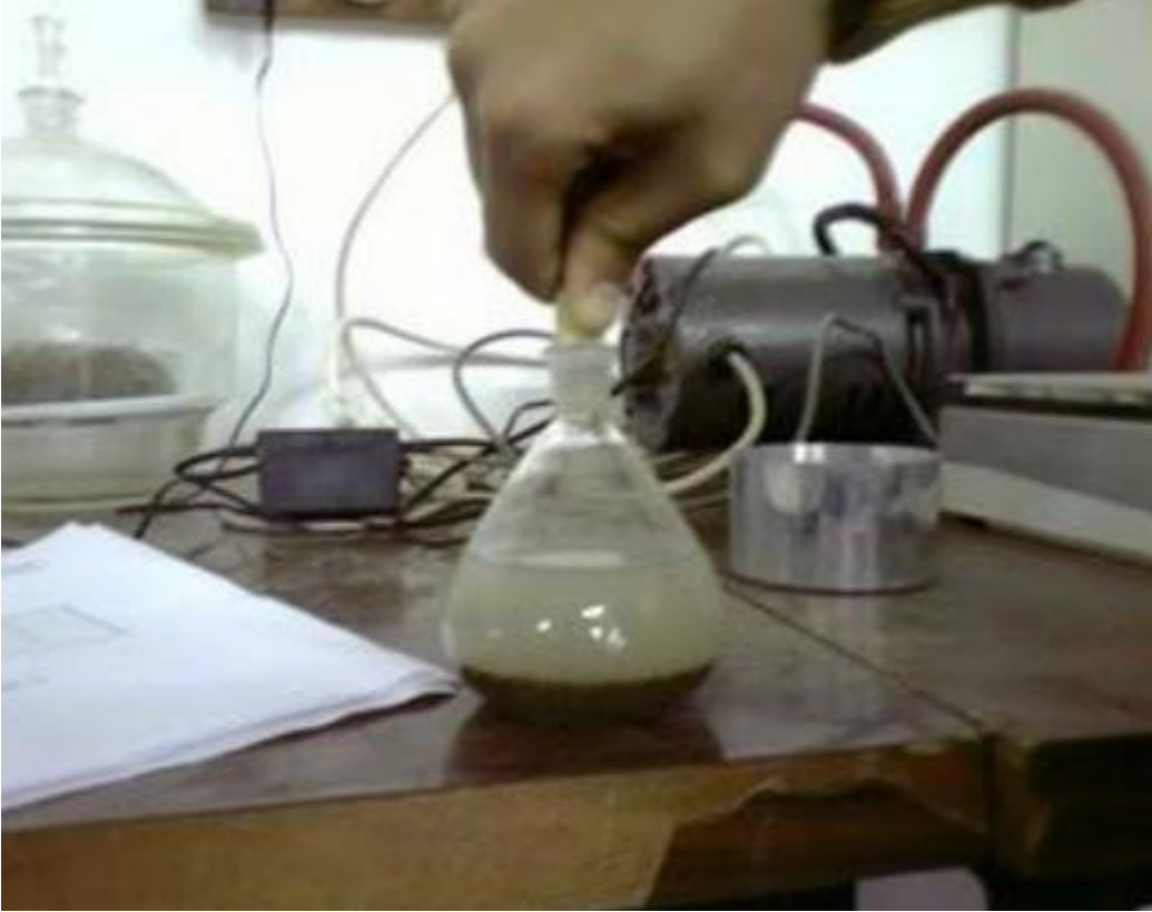
Şekil 4.1 Özgöl ağırlık deney seti
