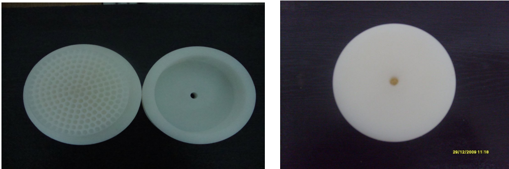
Şekil 3.4. Polietilen Malzemeden imal edilmiş olan model yanma odası
