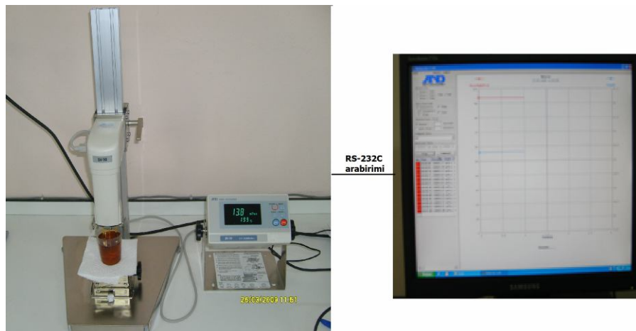
Şekil 3.2. Denemelerde Kullanılan vibro-viskometre ve ölçüm sonuçlarının alınması
