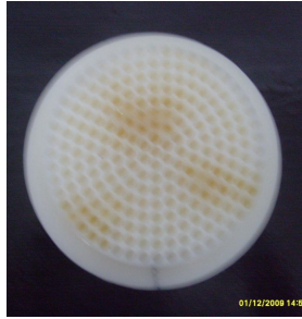
Şekil 4.5. Motorin örneğinin yanma odasında püskürtme dağılımının bölgelere göre değişimi
