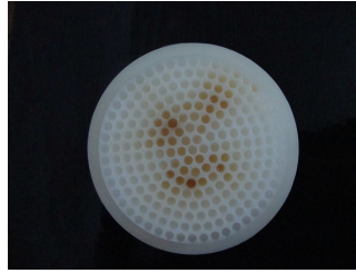
Şekil 4.7. Örnek 3'ün yanma odasında püskürtme dağılımının bölgelere göre değişimi
