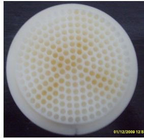
Şekil 4.11. Örnek 7'nin yanma odasında püskürtme dağılımının bölgelere göre değişimi
