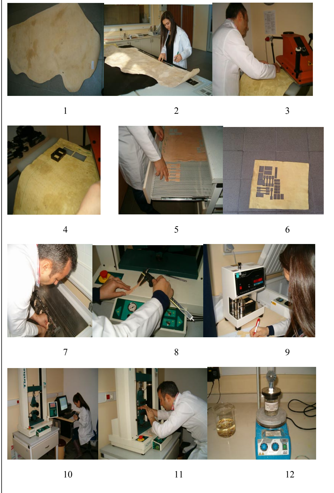
Şekil 3.6. Deri kalite tayini için numune alma ve testlerin yapılışı
