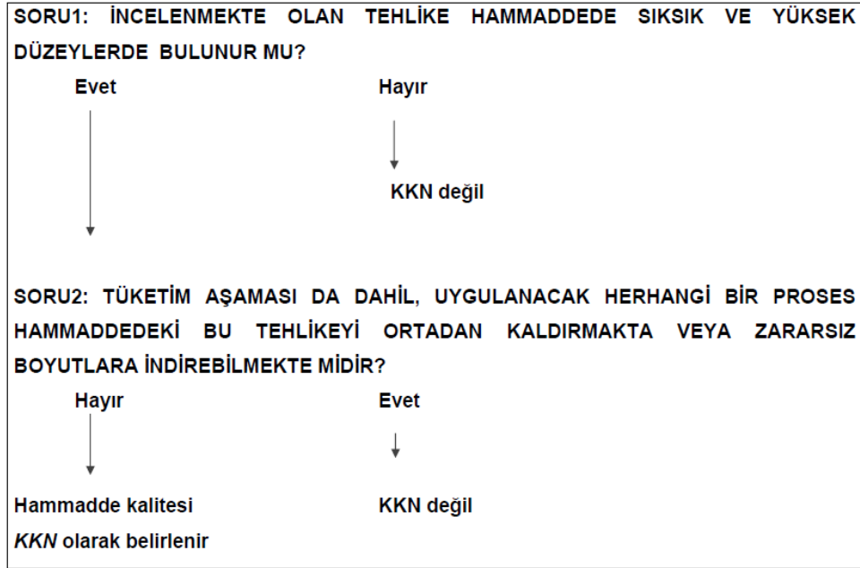
Şekil 3.2.2. Hammadeden kaynaklanabilecek tehlikelerin tespit edilmesinde kullanılan karar ağacı (Anonim 2003)
