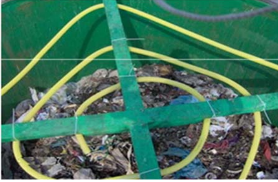
Şekil 5. Sızıntı Suyu Geri Devir Hortumları (Leakage Water Recirculation Hoses)
