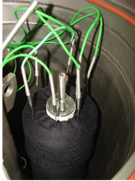
Şekil 3.5. İplik bobinlerine yerleştirilen termokupullar
