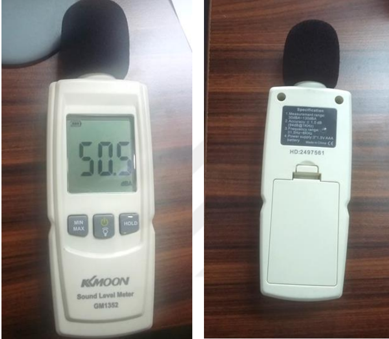
Şekil 8. İşletmede Gürültü Ölçümünde Kullanılan Sonometre (Ses Düzeyi Ölçer)
