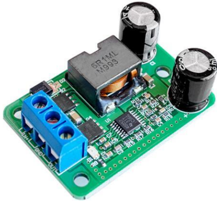
Şekil 3.7. DC-DC güç modülü (Güç Modülü, t.y.)
