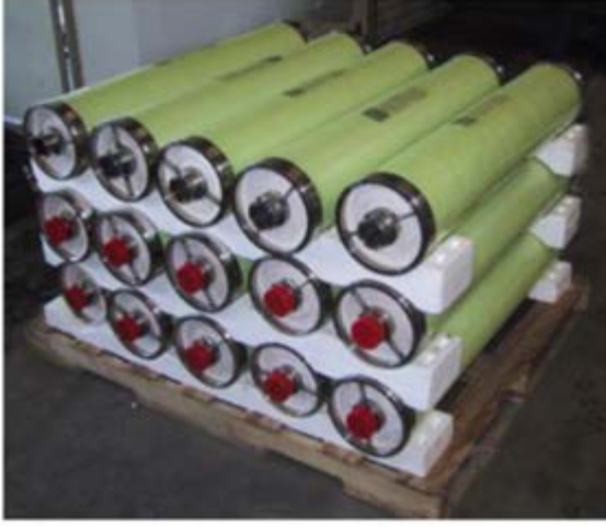
Şekil 2.6. Sprial-wound membran modülleri
