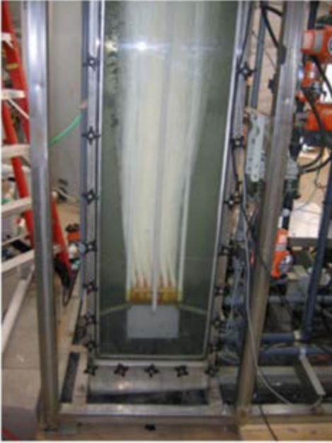
Şekil 2.4. Hollow-fiber membran modülü
