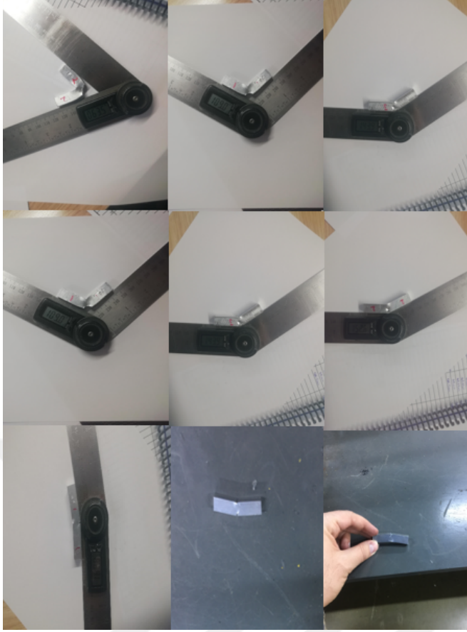
Şekil 4.18. Çentik darbe deneyi sonucu oluşan eğilme açıları
