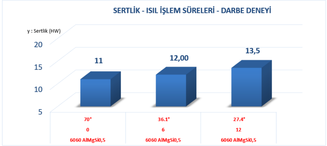
Şekil 4.27. 6060 alaşımı test numunesine ait farklı ısıl işlem süresinin malzeme sertliğine ve deformasyon açısına etkisi
