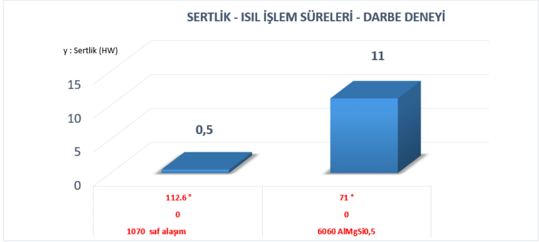
Şekil 4.24. 1070 ve 6060 alüminyum alaşımlarının ısıtılma öncesi çentik darbe deneyi deformasyon açıları
