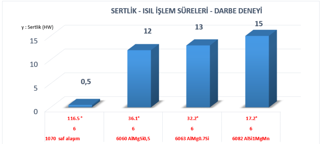
Şekil 4.25. 6 saat ısıtılma görmüş test numunelerinde çentik darbe deneyi sonucu meydana gelen deformasyon açıları
