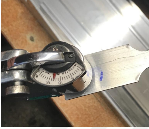
Şekil 3.5. Sertlik ölçüm metodu
