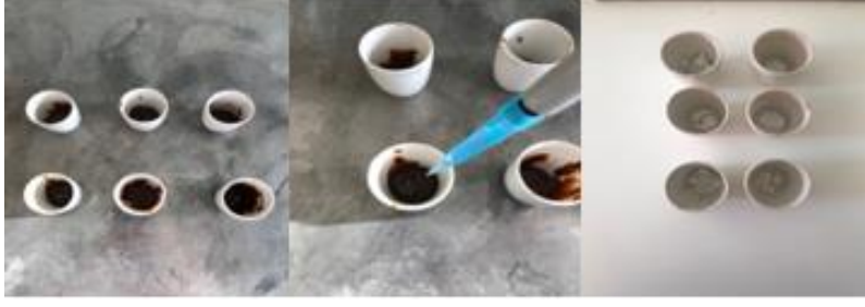
Şekil 3.3. Kül tayini aşamaları
