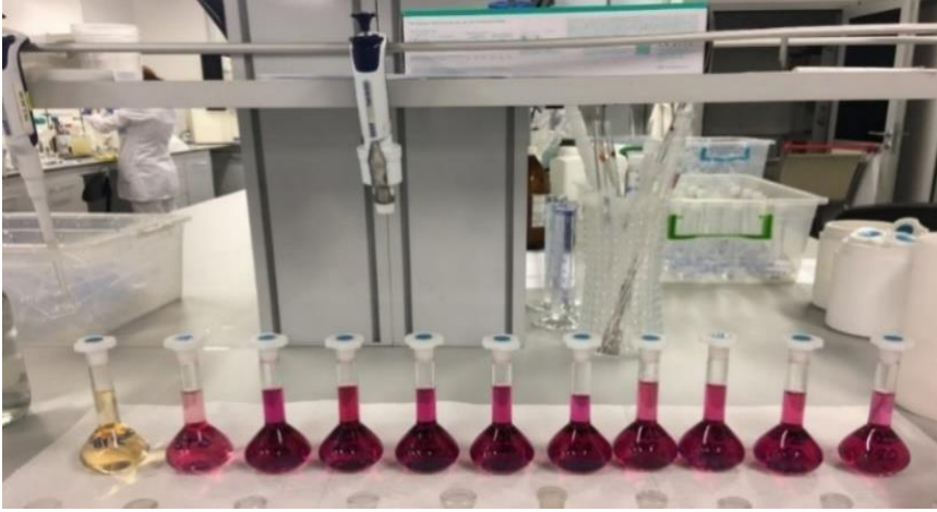
Şekil 4.3. Cr +6 tayini için hazırlanan numunelerin görünümü
