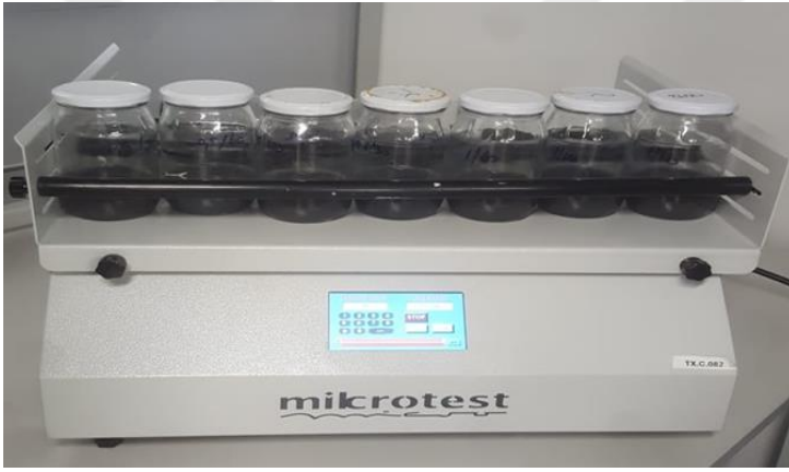
Şekil 4.1. Orbital çalkalayıcıda numunelerin karıştırılma süreci
