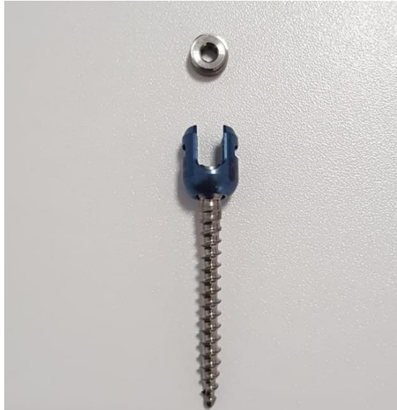
Şekil 13: Poliaksiyel vertebral pedikül vidası ve rod sistemine konneksiyonda kullanılan vida kapağı
