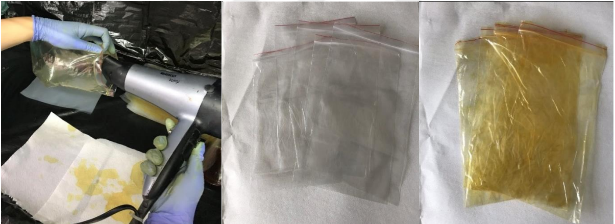
Şekil 3.6. Propolisli kilitli poşetin kurutulması işlemi, kilitli poşetin propolisli solüsyonu uygulamadan öncesi ve uygulandıktan sonrası görünümü
