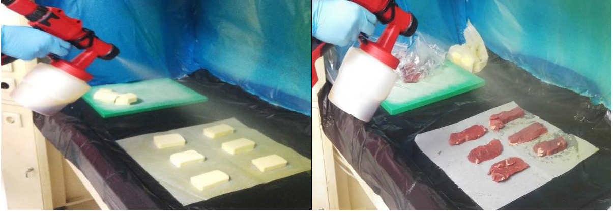
Şekil 3.9. Propolisli propilen glikol solüsyonunun et ve kaşar peynirine kompresör yardımıyla püskürtülmesi
