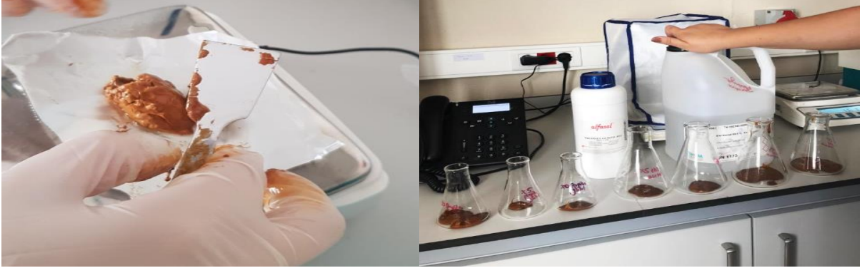
Şekil 3.2. Propolislin solüsyonları hazırlamak için tartımı ve üzerine propilen glikol ve etil asetat konulmak üzere erlenlere aktarılması
