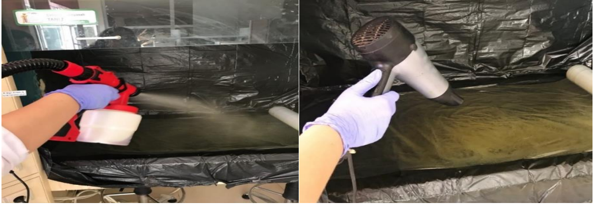
Şekil 3.3. Propolisli etil asetat solüsyonun streç filme kompresör yardımıyla püskürtülmesi ve kurutulması işlemi
