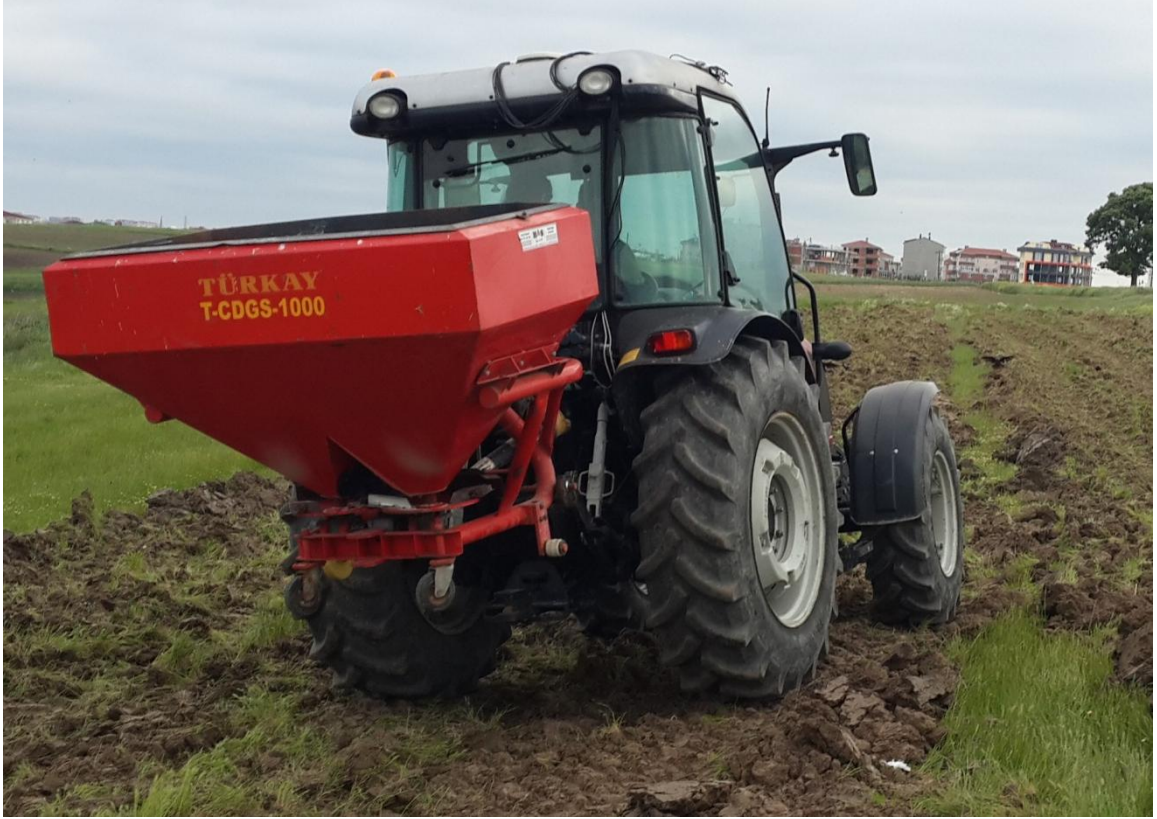
Şekil 43. Testlerde kullanılan gübre serpme makinası
