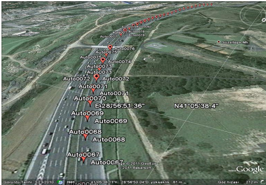
Şekil 59 - TEM'de 110-120 km hızla hareket halinde CORS-TR'ye bağlı GNSS alıcısı ile elde edilen rota çizgisi
