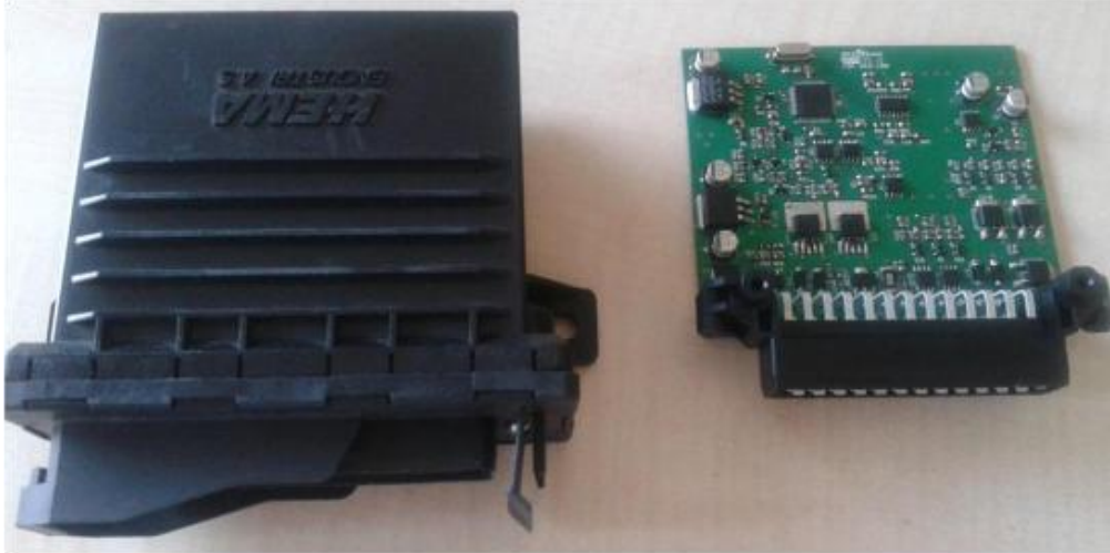
Şekil 36. Dümenleme elektronik kontrol ünitesi
