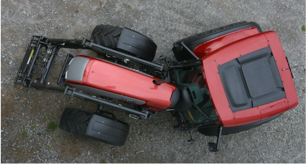
Şekil 10. Belden kırmalı dümenleme Sistemi (Anonim 2013c)
