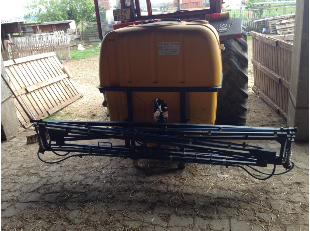
Şekil 44. Testlerde kullanılan tarla pülverizatörü
