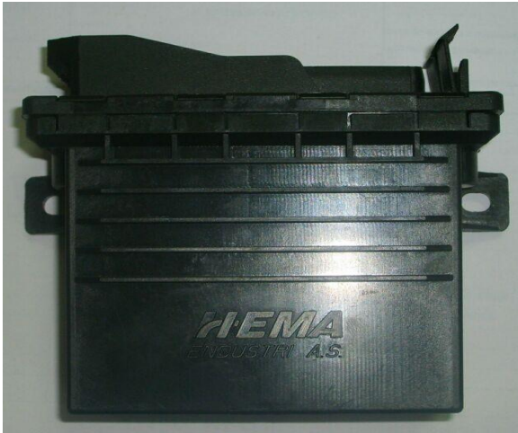
Şekil 33. Elektro-Hidrolik Kontrol Ünitesi
