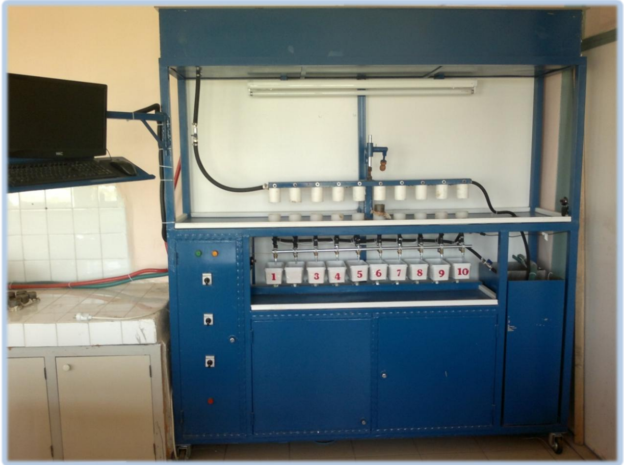
Şekil 3.11. Bilgisayar kontrollü, sabit su seviyeli permeabilite cihazı (Namık Kemal Üniversitesi Ziraat Fakültesi Toprak Bilimi ve Bitki Besleme Bölümünde yapılmıştır)
