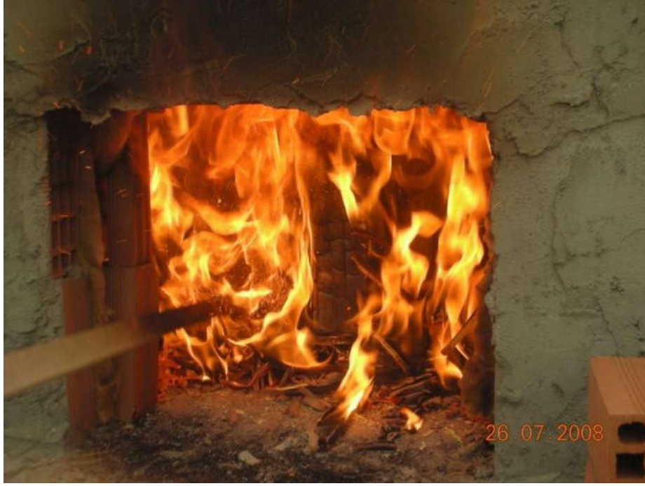
Şekil 3.10. Birinci deney numunesinin yangın etkisinin 13. dakikasındaki durumu
