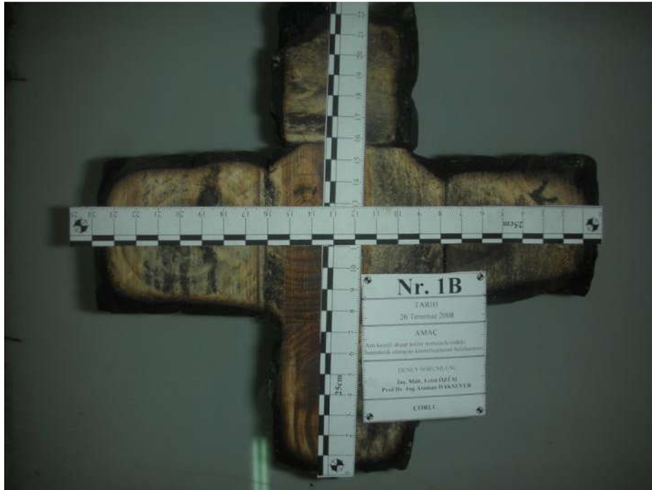
Şekil 3.23. Yangın etkisine maruz kalmış 1B deney numunesinin kesiti
