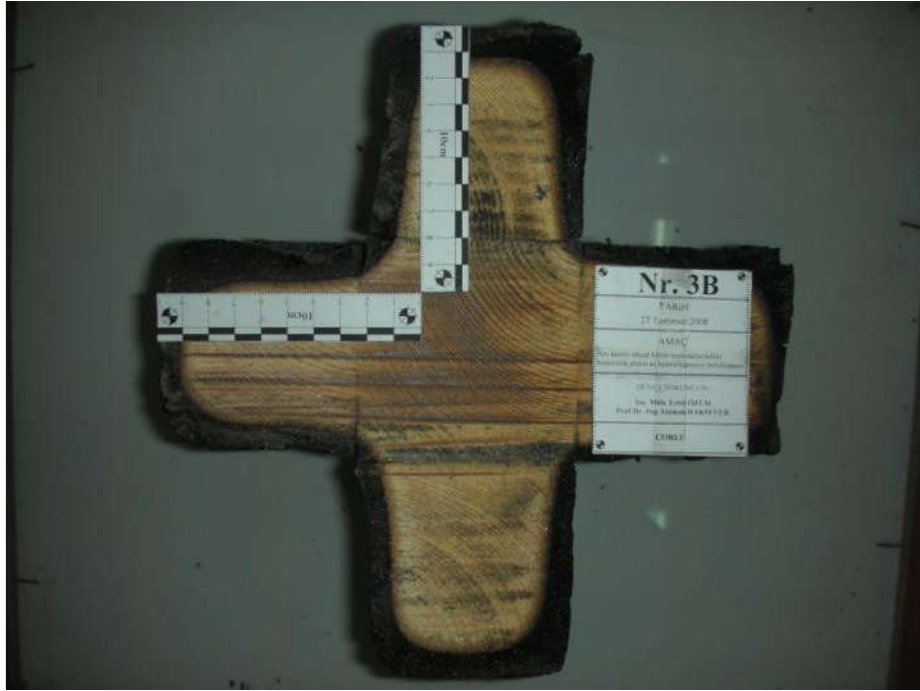
Şekil 3.27. Yangın etkisine maruz kalmış 3B deney numunesinin kesiti
