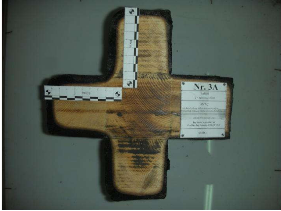
Şekil 3.26. Yangın etkisine maruz kalmış 3A deney numunesinin kesiti
