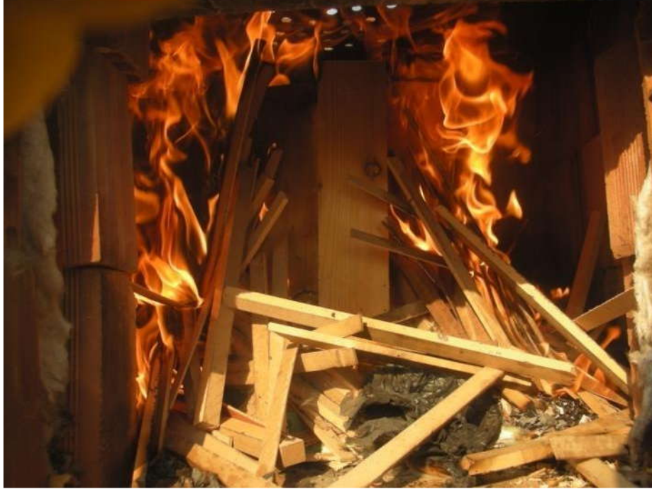
Şekil 3.18. Üçüncü deney numunesinin yangın etkisinin 3. dakikasındaki durumu
