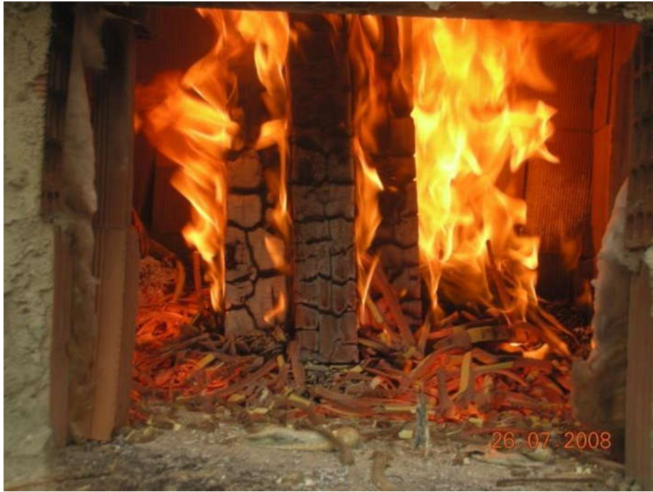
Şekil 3.11. Birinci deney numunesinin yangın etkisinin 18. dakikasındaki durumu
