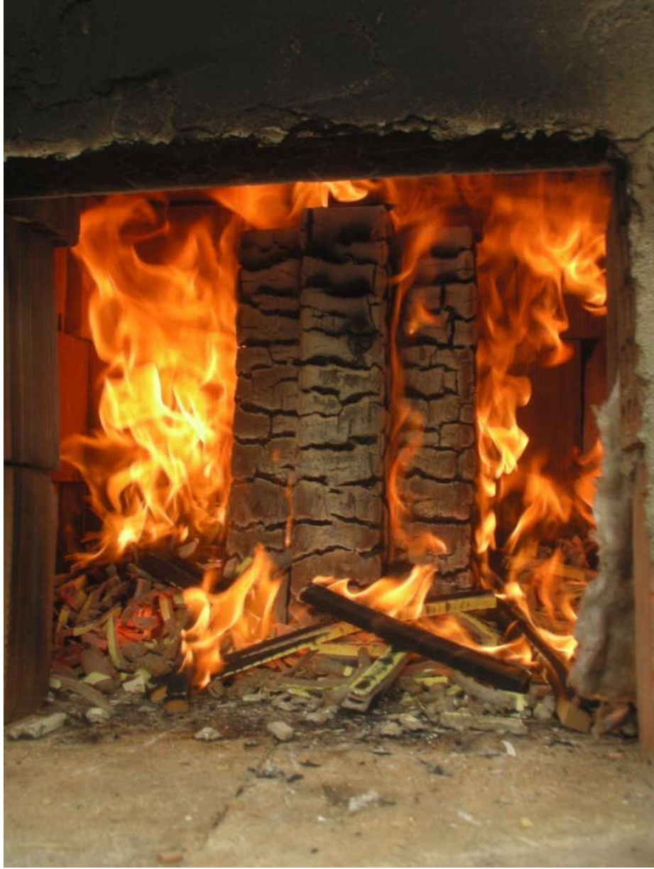
Şekil 3.19. Üçüncü deney numunesinin yangın etkisinin 20. dakikasındaki durumu
