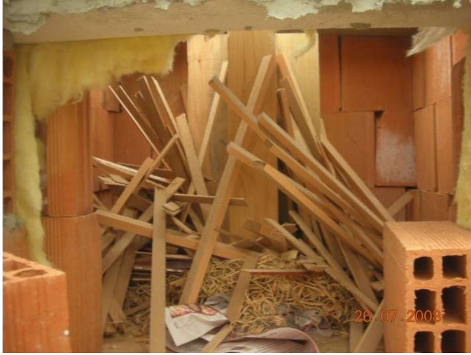
Şekil 3.9. Birinci deney numunesinin yangın odası içerisine yerleştirilmesi
