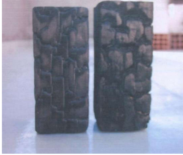
Şekil 2.8. Yanma etkisine maruz kalmış ahşap eleman görünüşü
