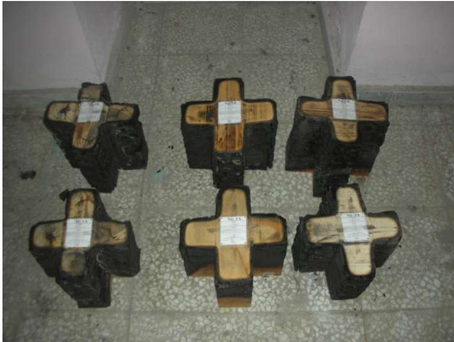
Şekil 3.21. Kesitleri alınarak numaralandırılan deney numunelerinin görünüşü
