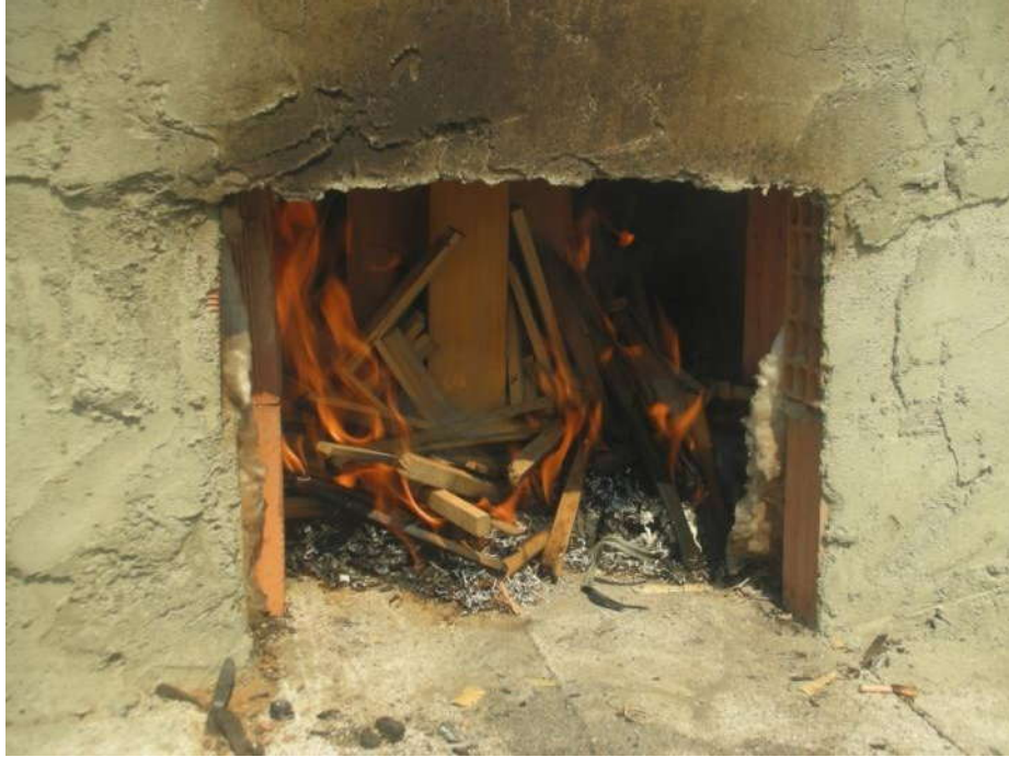
Şekil 3.14. İkinci deney numunesinin yangın etkisinin 2. dakikasındaki durumu
