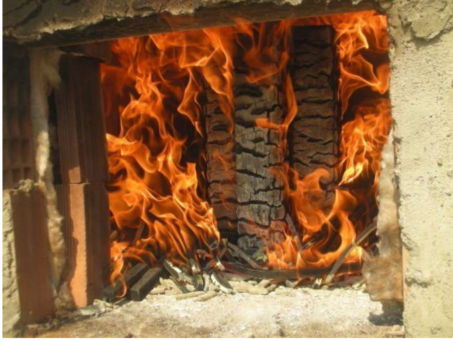
Şekil 3.15. İkinci deney numunesinin yangın etkisinin 16. dakikasındaki durumu
