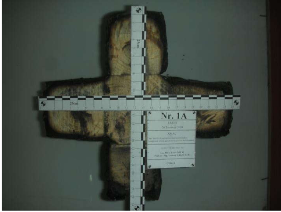
Şekil 3.22. Yangın etkisine maruz kalmış 1A deney numunesinin kesiti
