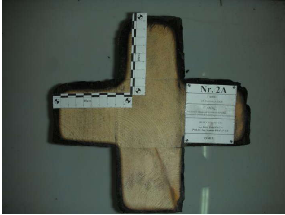
Şekil 3.24. yangın etkisine maruz kalmış 2A deney numunesinin kesiti
