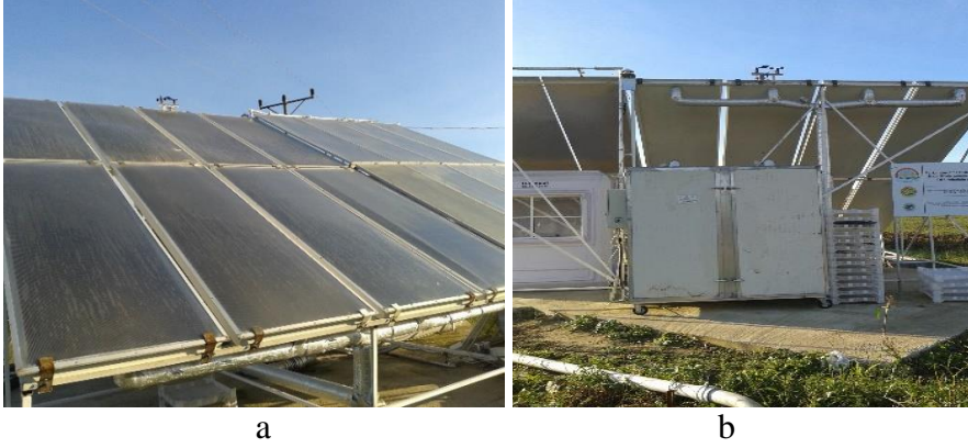
Şekil 3.14. Güneş kolektörlü kurutma sistemi
