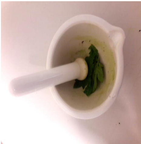
Şekil 3.6. SÇKM (brix) ölçümü yapılırken yaprakların ezilmesi
