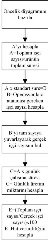
Şekil 2.18. Darboğaz yöntemi algoritma akış diyagramı
