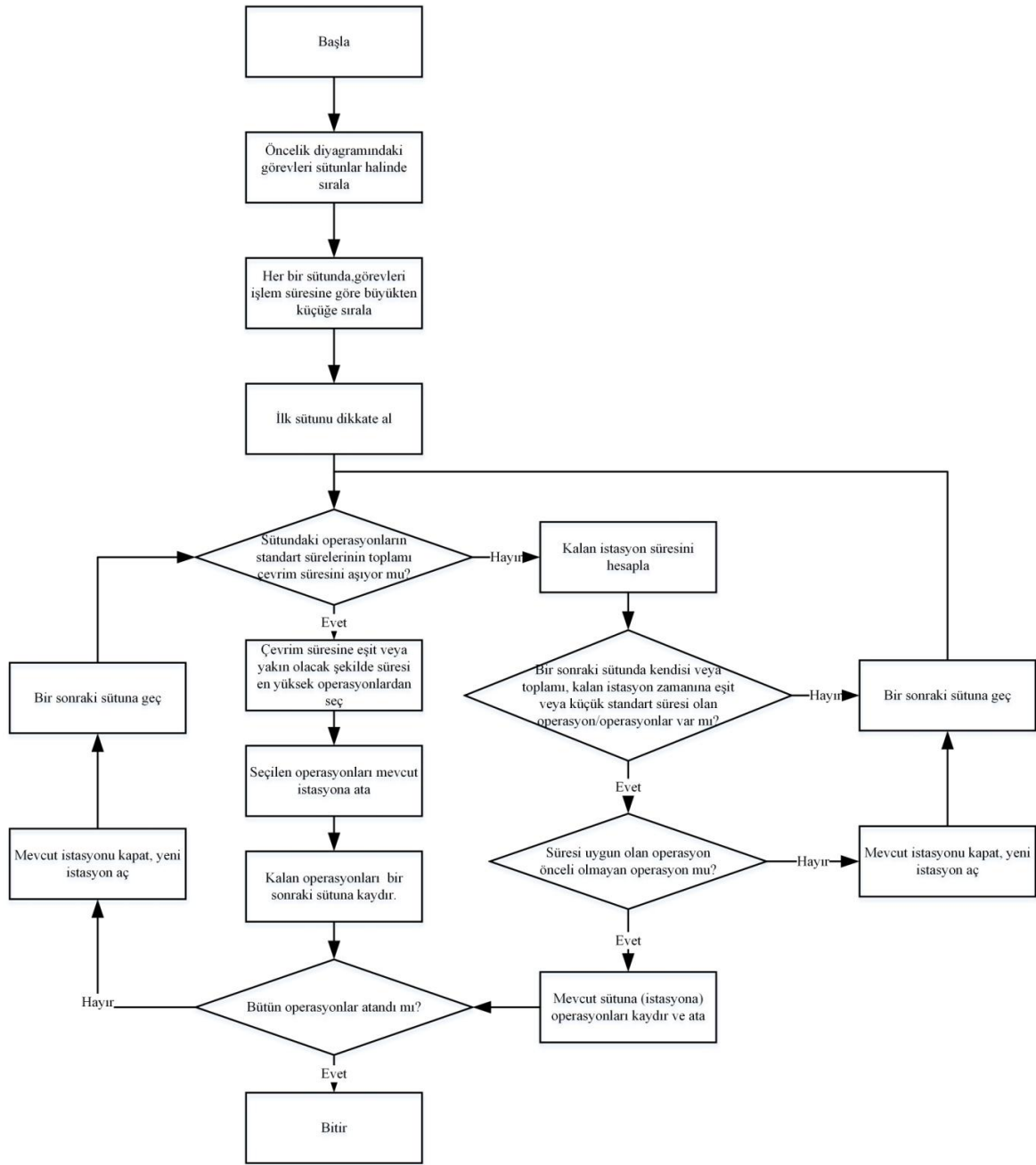
Şekil 2.22. Kilbridge-Wester yöntemi algoritma akış diyagramı
