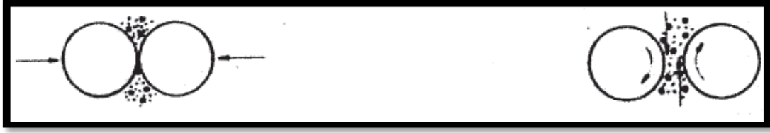
Şekil 1.31. Atritör değirmeninde öğütme esnasında oluşan hareketler(Milli, 2017)
