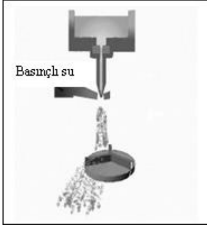
Şekil 1.19. Döner disk ile atomizasyon yöntemi(Milli, 2017)
