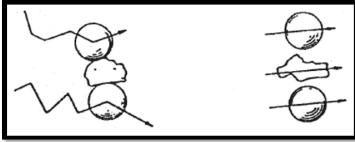
Şekil 1.32. Atritörde toz şarjı ile bilyaların hareketi(Milli, 2017)
