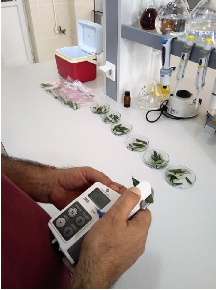
Şekil 3.17. Spad klorofilmetre ile klorofil ölçümü
