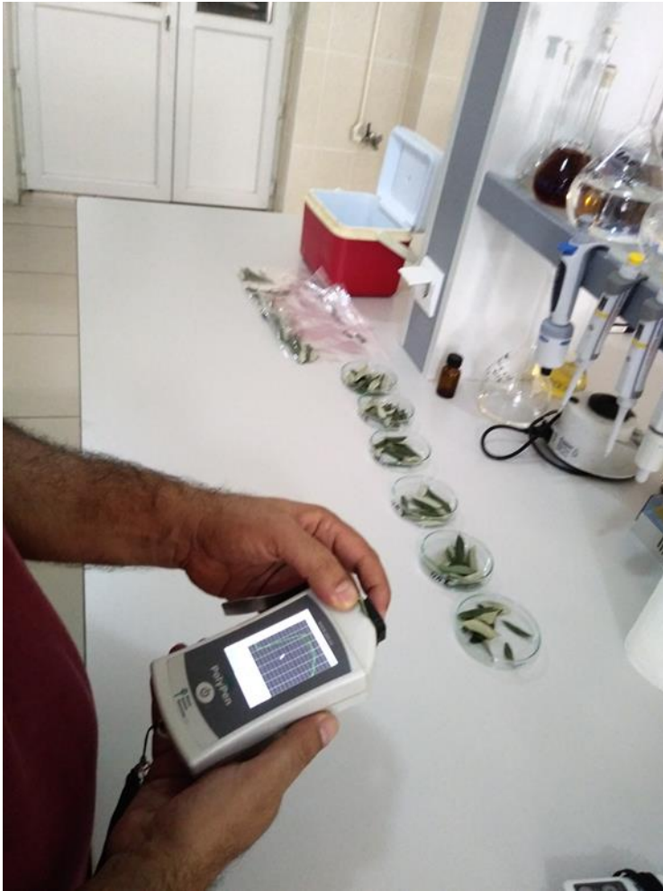
Şekil 3.21. Spektrometre ile yaprak yansımalarının ölçülmesi
