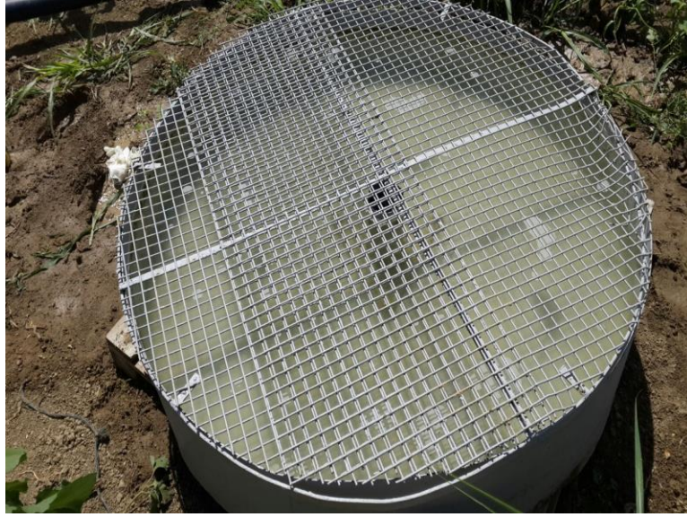
Şekil 3.4. Deneme alanında kullanılan A sınıfı buharlaşma kabı
