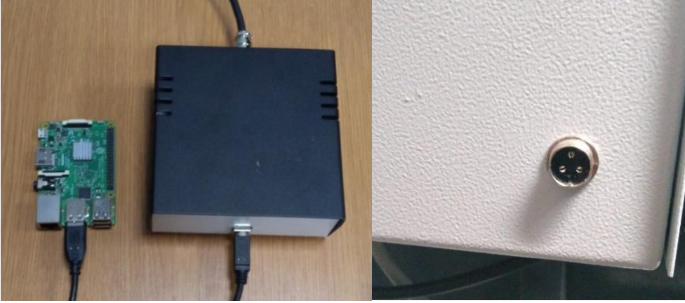
Şekil 3.4. raspberry pi 3, arduino ve lojik çıkış portu
