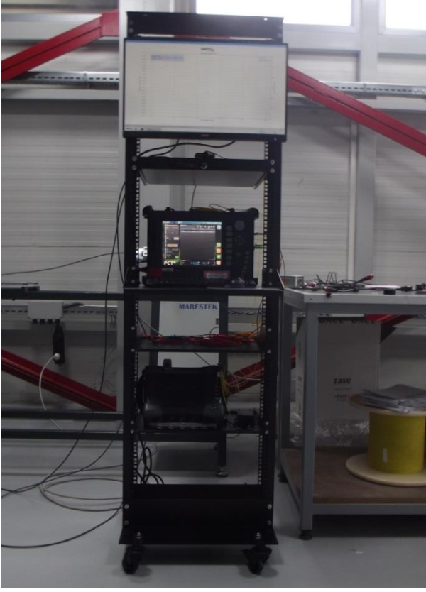
Şekil 3.5. Fiber optik kablo test platformu
