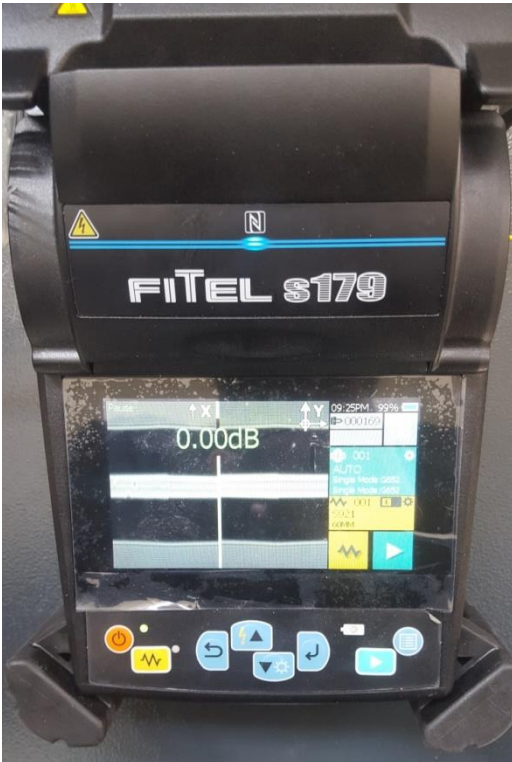
Şekil 3.20. Ek işleminin gerçekleştirilmesi ve kayıp değeri
