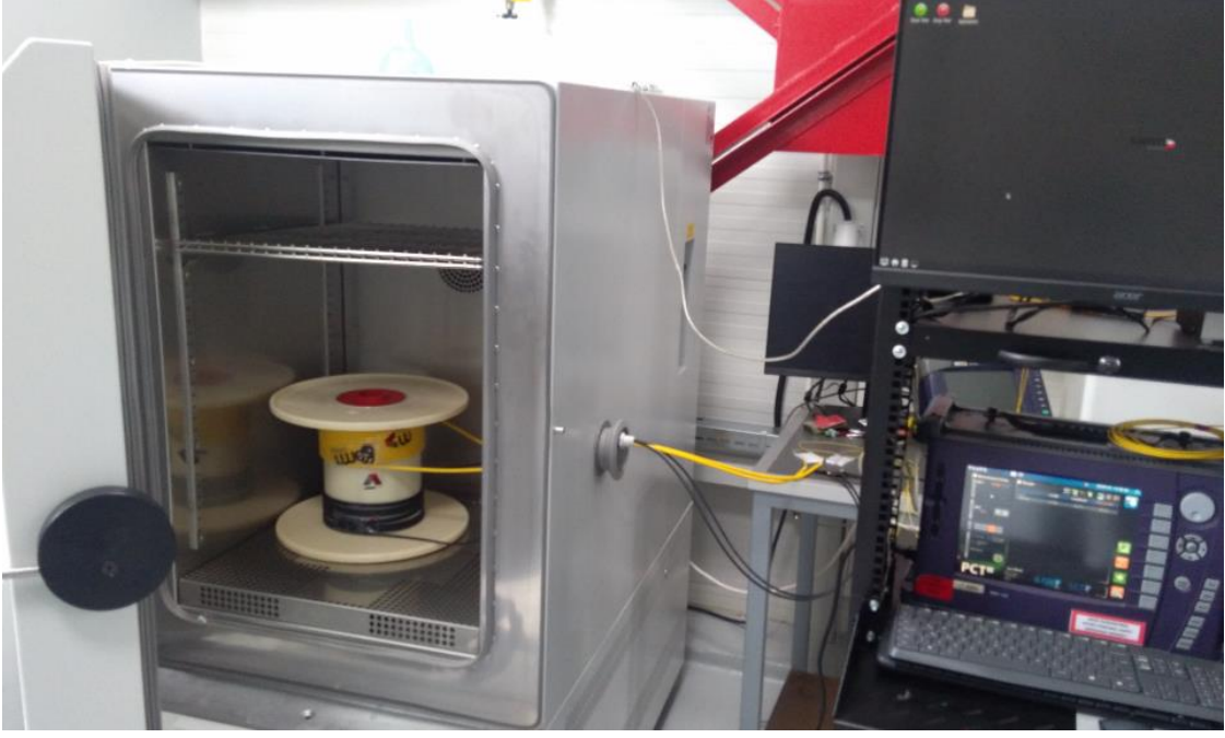
Şekil 4.12. İki farklı kablonun aynı anda testi için cihaza yerleştirilmesi
