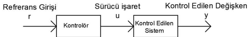
Şekil 3.1. Açık çevrim kontrol sisteminin öğeleri (Kuo 1999)
