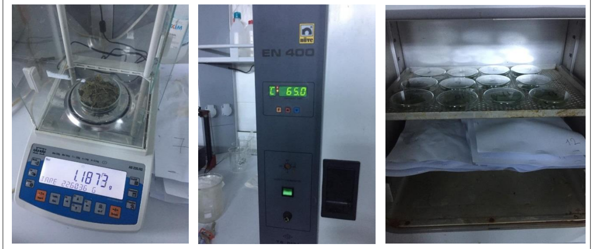
Şekil 3.8. Hasat döneminde yaprakların etüvde kurutulması ile yaş ve kuru ağırlıklarının belirlenmesi
