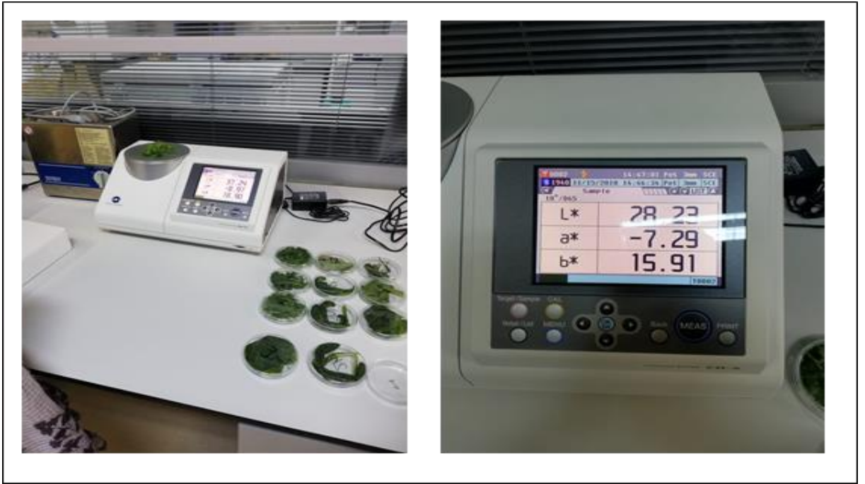
Şekil 3.14. Homojen olmayan materyallerin renklerinin ölçümüne uygun, oldukça büyük bir ölçüm alanına sahip olan HunterLab D25LT ile yaprak renk ölçüm cihazı
