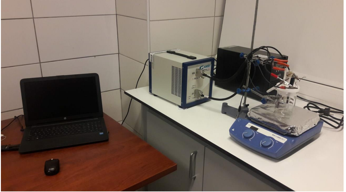
Şekil 3.2. CdTe ince film yarıiletkenlerinin büyütülmesinde kullanılan sistem
