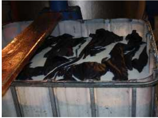
Şekil 2.9 Daldırma ile reçine aplikasyonu (Köksal,2015)
