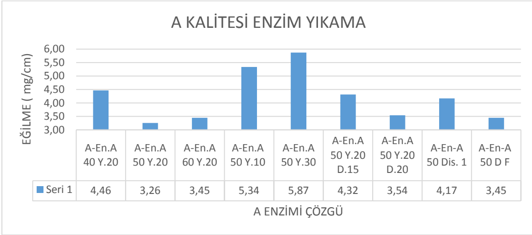
Şekil 4.42 A kalitesinin, enzim yıkamanın A enzimine ait çözgü yönünde eğilme dayanımı
