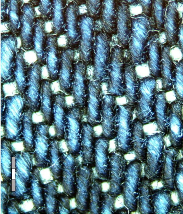
Şekil 4.76 A kalitesinin, A Enzimine ait yıkama süre (A:10,B:20,C:30) Numuneleri ve D: işlemsiz ve B numunesi yakın çekim karşılaştırması
