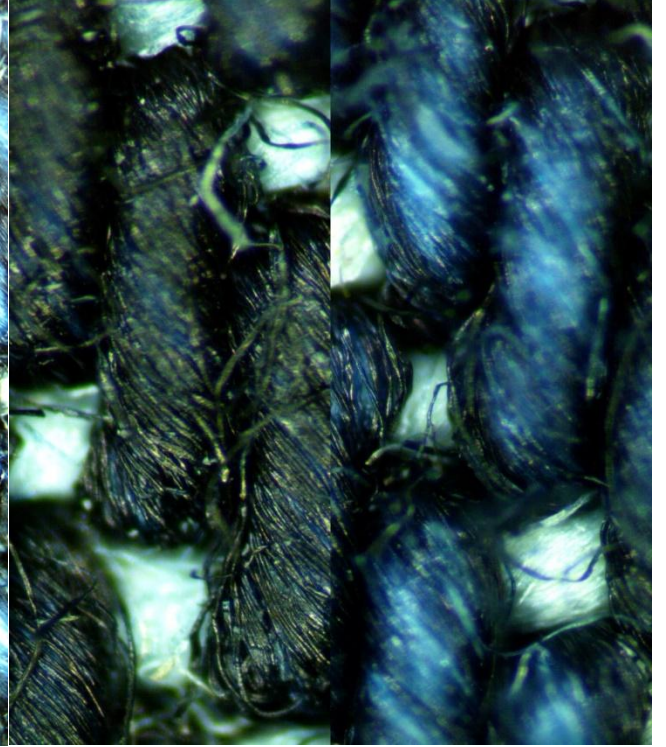
Şekil 4.76 A kalitesinin, A Enzimine ait yıkama süre (A:10,B:20,C:30) Numuneleri ve D: işlemsiz ve B numunesi yakın çekim karşılaştırması
