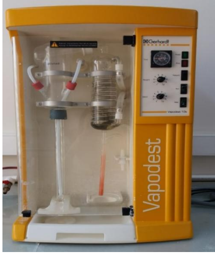
Şekil 3.11. Protein analizi yapılan Kjeldahl cihazının görüntüsü
