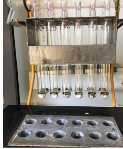
Şekil 3.11. Protein analizi yapılan Kjeldahl cihazının görüntüsü
