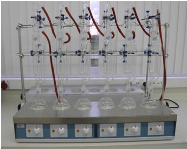
Şekil 3.10. Ham yağ oranı tayin etmede kullanılan cihaz
