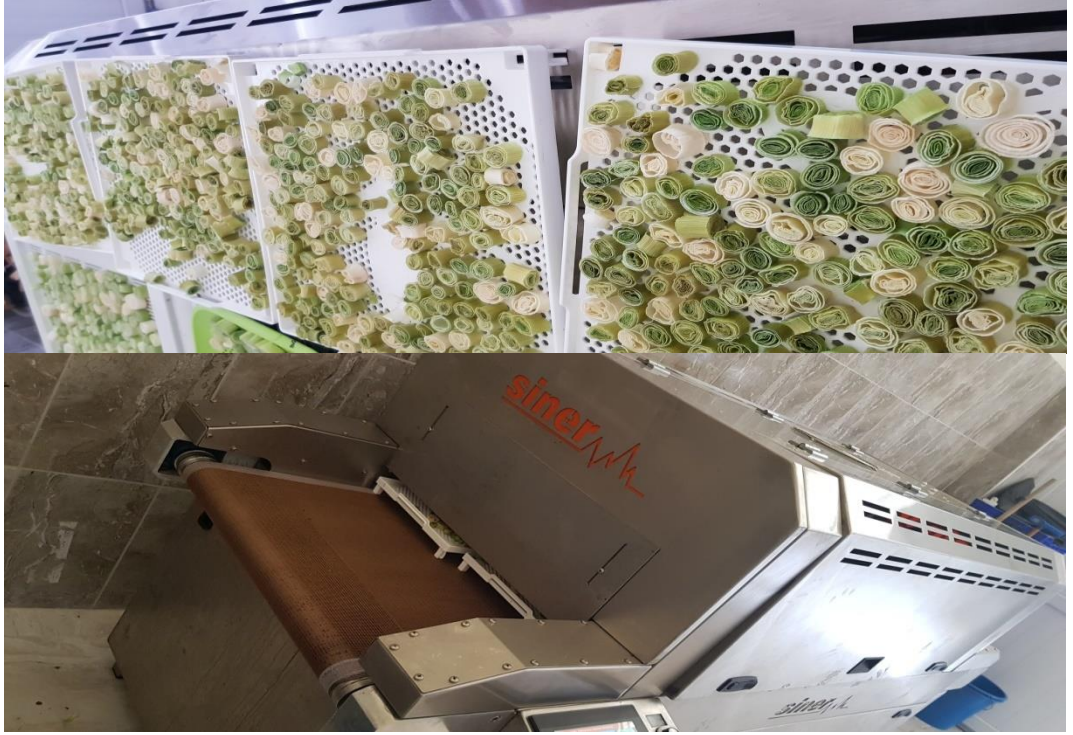
Şekil 3.5. Bantlı sistem laboratuvar tipi mikrodalga kurutucu kurutma işlemleri
