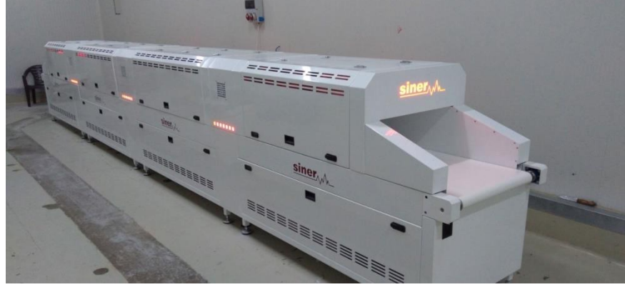
Şekil 2.10. Bantlı sistem mikrodalga kurutucu (Anonim 2018b)
