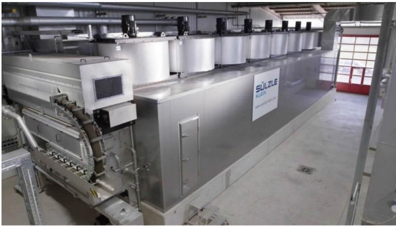
Şekil 4.19. Dünya uygulamalarında gübrenin kurutulması için kullanılan örnek bir kurutucu
