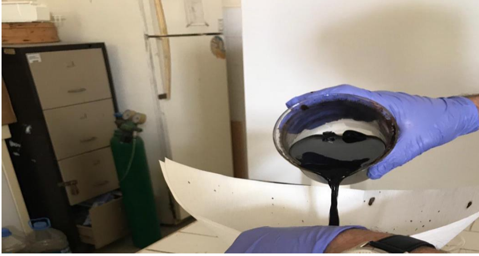
Şekil 3.2. Manyetik Demir Kaplı Pomzanın Süzme İşlemi
