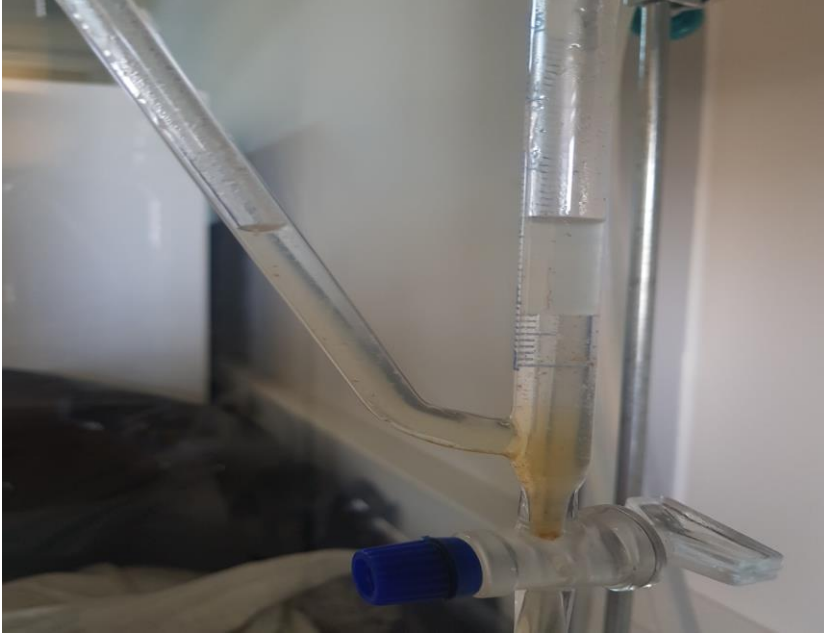
Resim 3. 2. 7. 2: Klavenger yöntemi ile ayrılan yağ fazı
