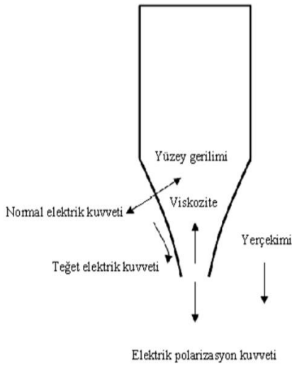
Şekil 2.8. Kapiler ucundaki damlanın üzerine etki eden kuvvetler (Tanrıverdi 2006)
