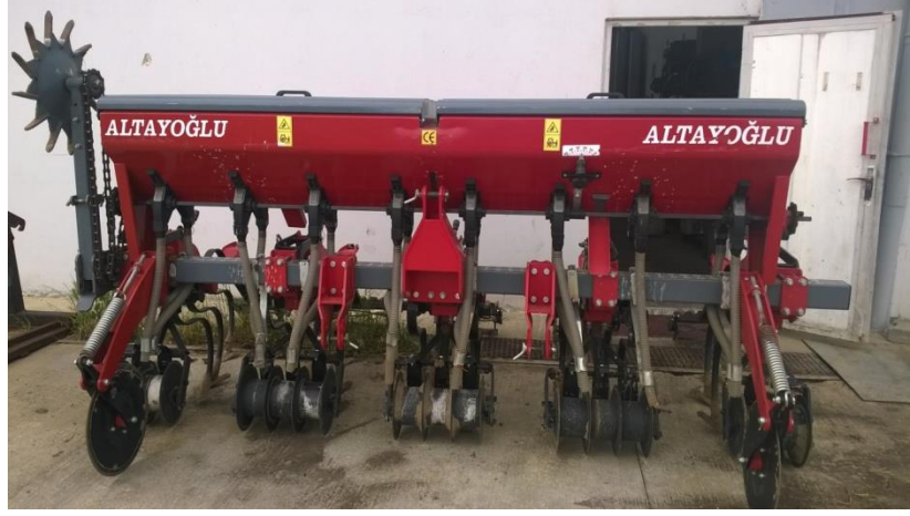
Şekil 3.4. Geliştirilmiş model yaylı ara çapa makinesi
